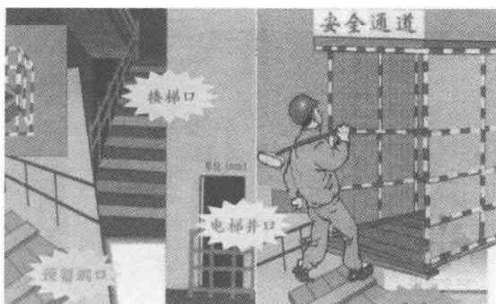
图 1-7 通道口、预留洞口、楼梯口、电梯井口
