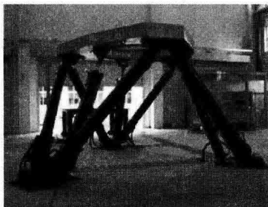
图 1-22 哈尔滨工业大学研制的大承载能力 电伺服驱动六自由度运动平台
