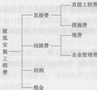
图 1-1-1 建筑安装工程费的构成
