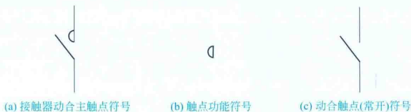
图1 接触器动合主触点符号组成
