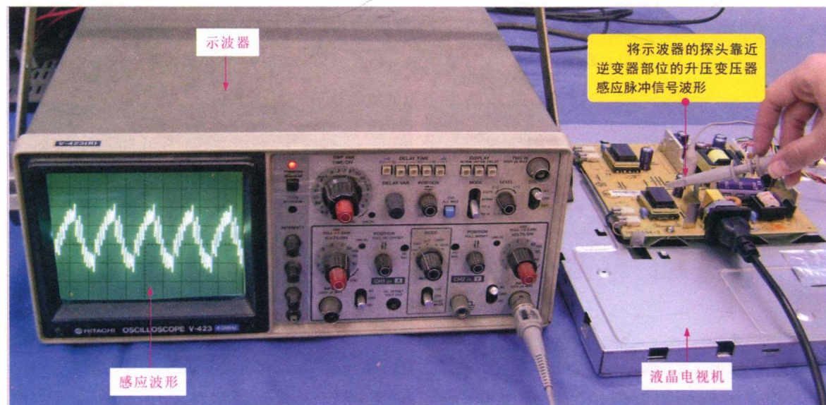
图 1-14 用示波器检测液晶电视机
