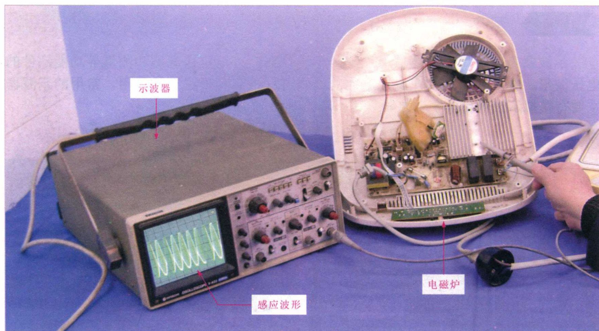
图 1-13 用示波器检测电磁炉
