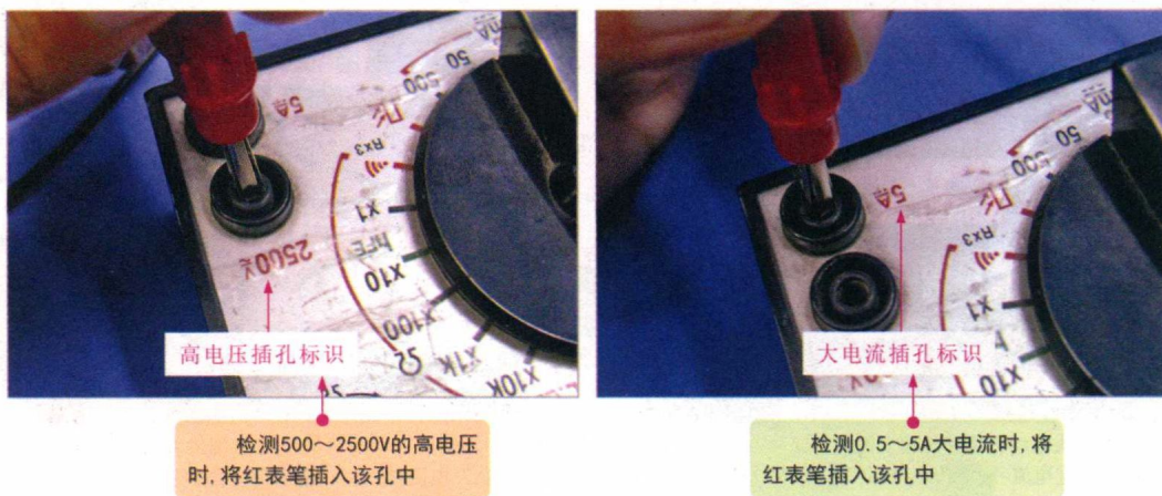
图 1-7 指针万用表其他孔的连接
