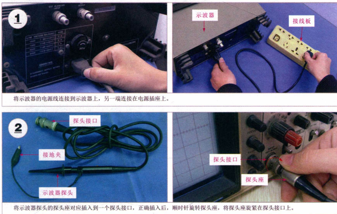
图 1-15 示波器各连接线的连接方法
