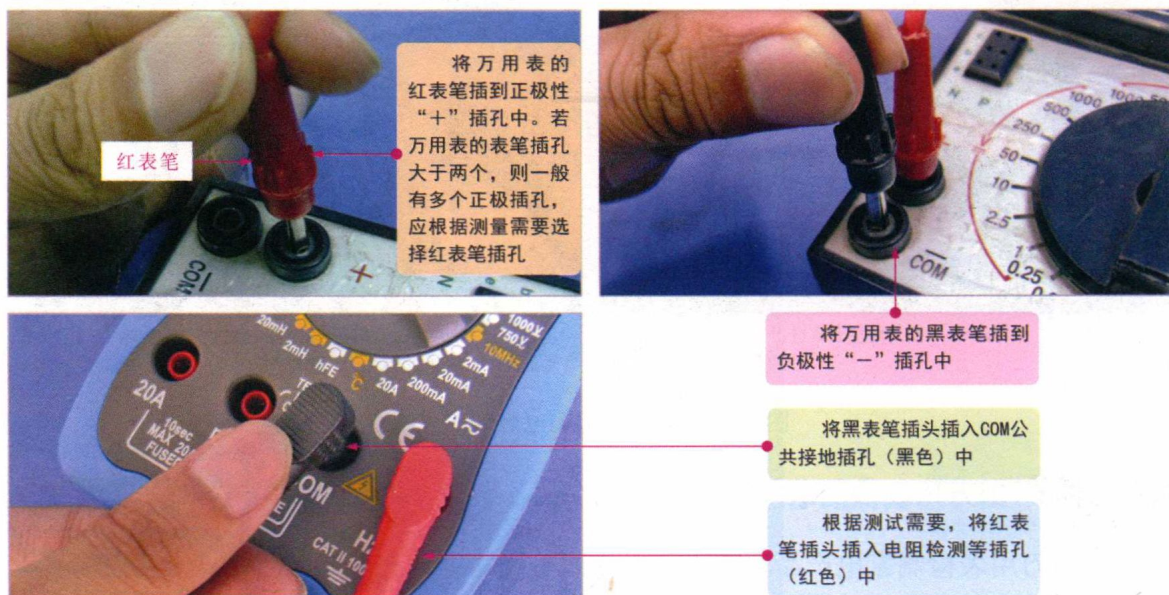
图 1-6 万用表测量表笔的连接
