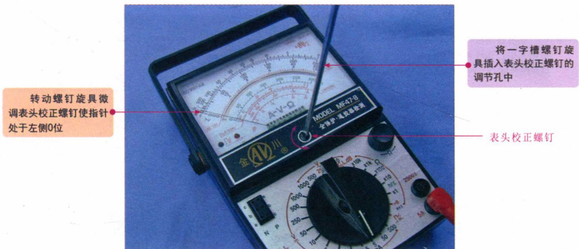
图 1-8 指针万用表表头校正的方法
