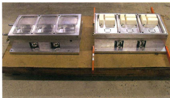
a) 机械加工制造用于生产塑料食品包装盒的模具
