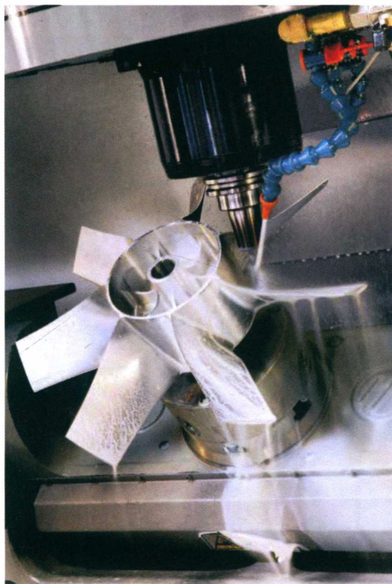
图 1-5 当代最先进的 CNC 机床能够在程序控制下实现无人监控运行并加工出十分复杂的形状
