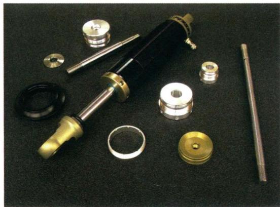
图 1-6 赛车比赛中用的减振器零件和组装好的减振器
