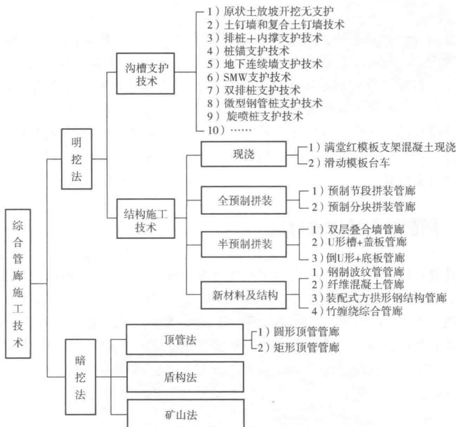
图 1-6 综合管廊结构形式及施工方法
