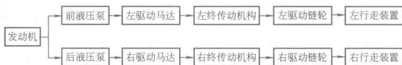
图 1-14 静液压传动系统的传动路线
