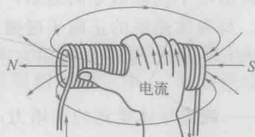
图 1-7 螺旋线圈产生的磁场
