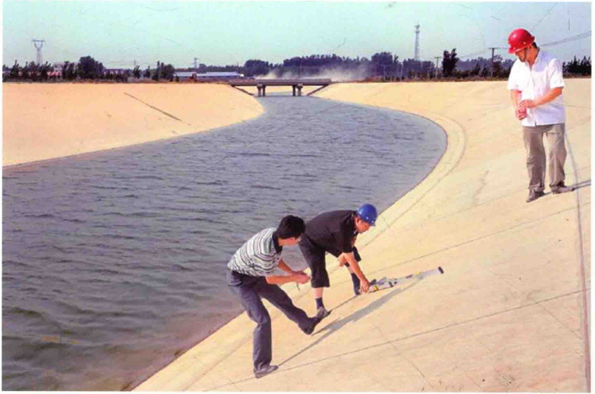
2012年8月，质量检测人员检查济南以东明渠段工程护坡衬砌平整度
