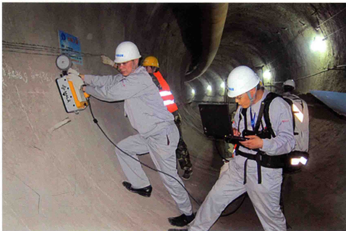
穿黄隧洞混凝土实体质量检测
