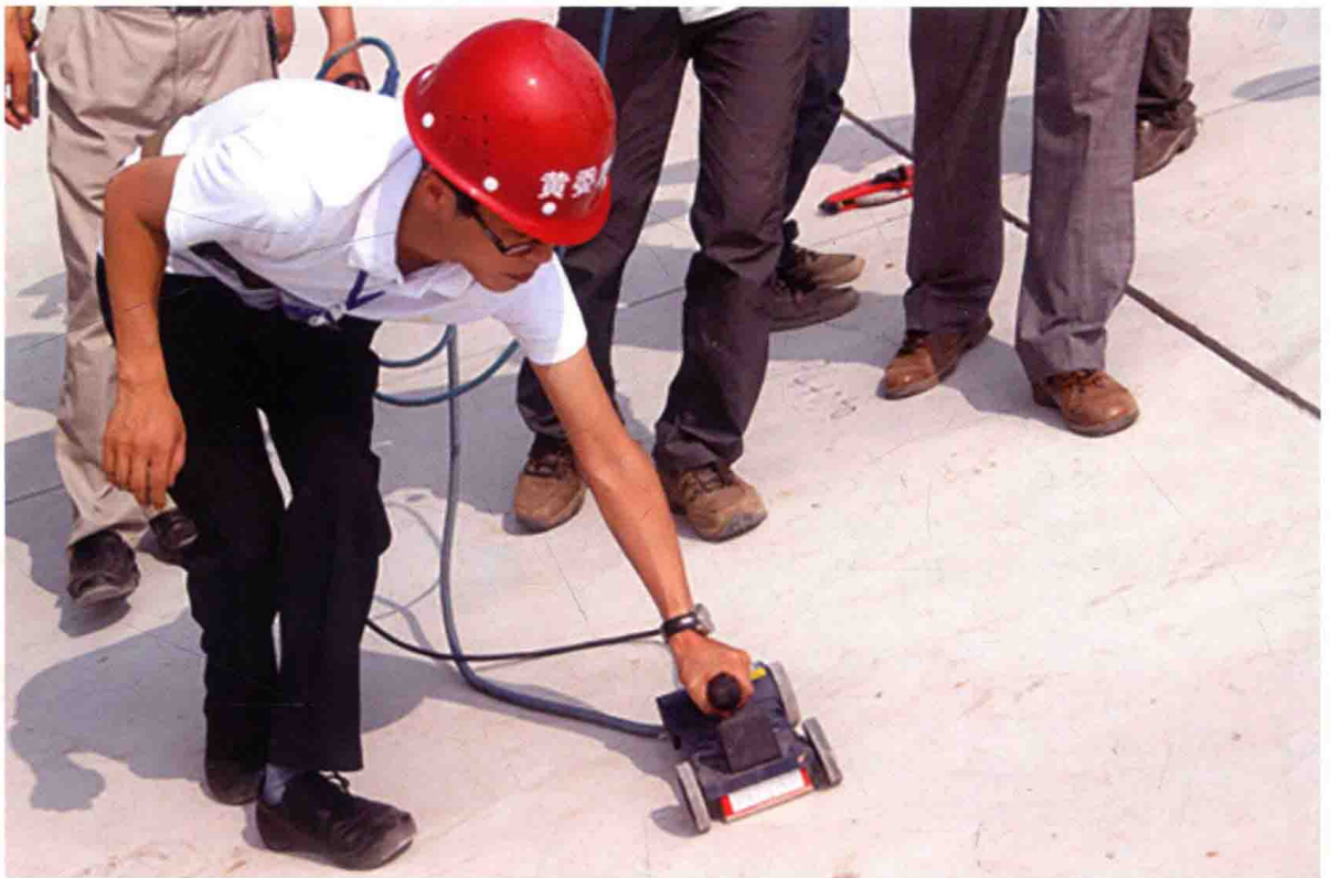
检测渠道混凝土衬砌厚度
