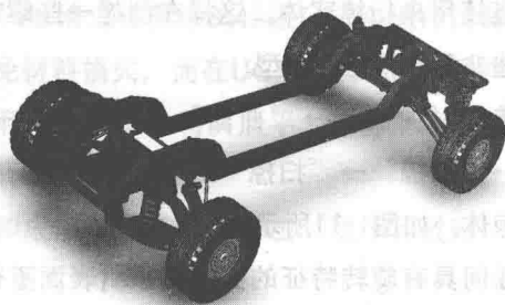
图1-8 B级曲面创建越野车底盘
