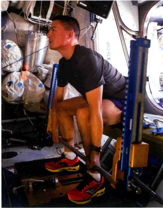
弹簧可以在微重力下模拟重物，同时可以节省开支
