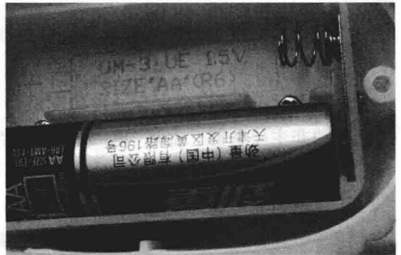
图1-1 不能反接的电池腔结构
