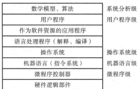
图 1-5 硬软件组成的结构层次示意图
