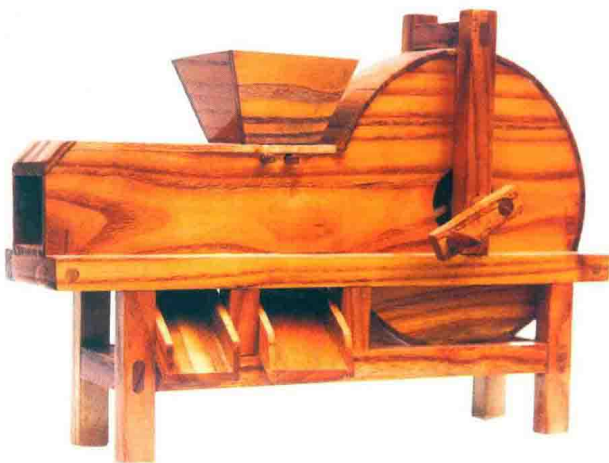
▲ 图中是仿照古代扇车的结构制成的扇车模型。扇车是一种粮食加工工具，可以利用风力扬去谷粒中的秕糠，得到的干净谷粒再进入碾磨工序。
