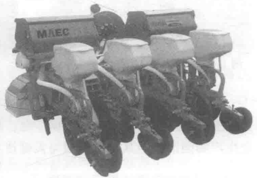
图 1-12 2BQX-4 玉米清垄免耕播种机
