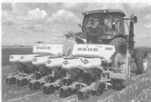
图 1-14 2605 气吸式免耕精密播种机
