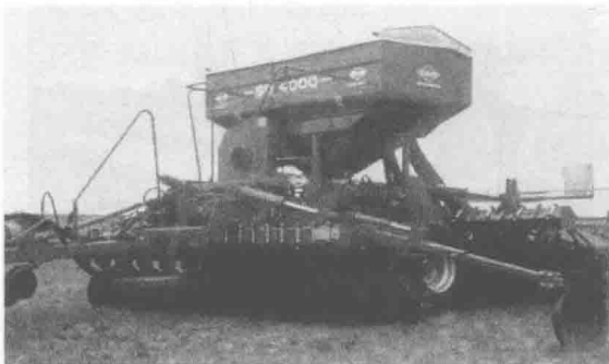
图 1-7 KUHN SD4000 免耕播种机
