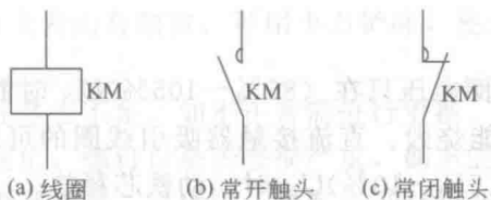
图 1-7 接触器的图形符号和文字符号
