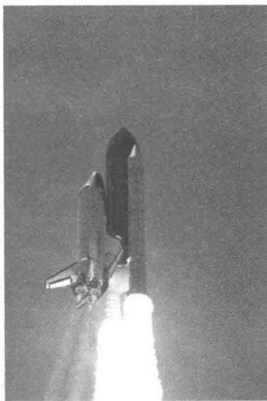
图1-2 航天飞机在发射时发动机放出大量的热量，因此温度显著升高。这张照片是“亚特兰蒂斯”号航天飞机发射至太空时三个主发动机的特写。因为发动机燃烧氢气和氧气，所以通过排气管释放出蒸汽（摘自 NASA/Rusty Backer and Michael Gayle. http://www.nasa.gov/mission_pages/shuttle/flyout/ssme.html ；高分辨率： http://www.nasa.gov/images/content/502050main_ssme_firing.jpg 。）
