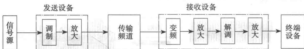
图 1-3 信号传输系统的框图
