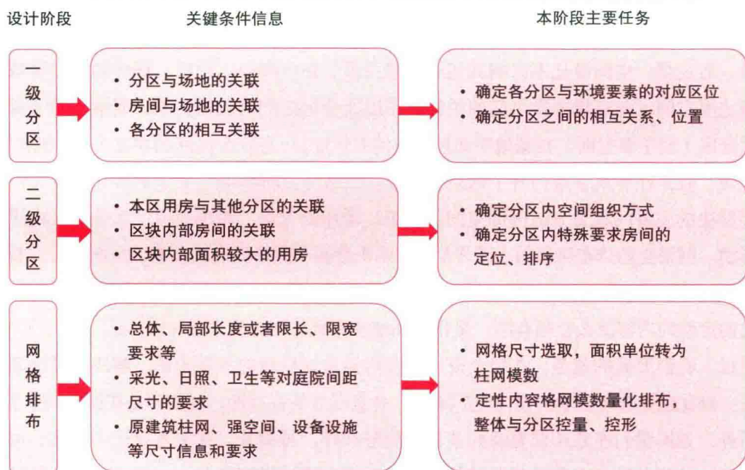
图1-2 系统逻辑思维设计方法设计阶段关键条件信息和主要任务
