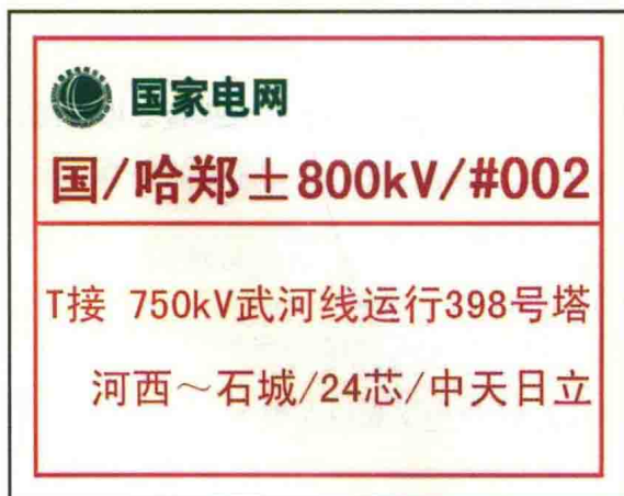
图 1-8 接续盒标识牌示例
