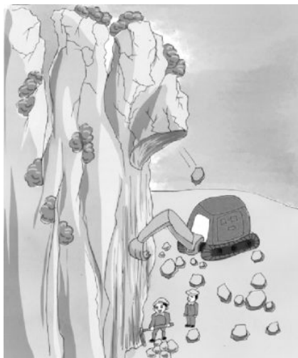
道路工程开挖诱发崩塌
