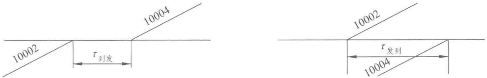
图 1-5 同方向列车不同时到发和不同时发到间隔时间
