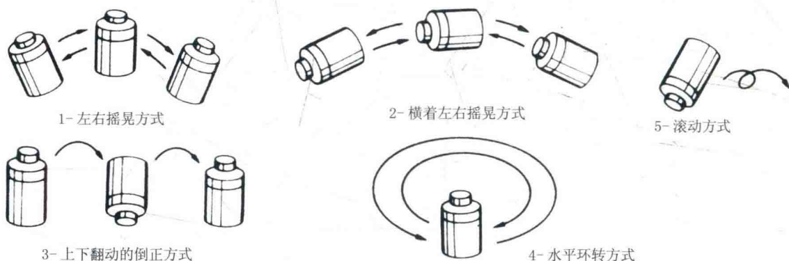
图4 显影罐显影的搅动方法
