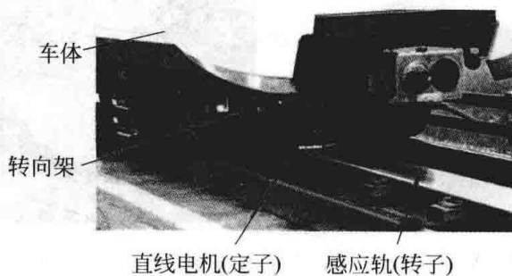
图 1-7 直线牵引电机在列车上的应用
