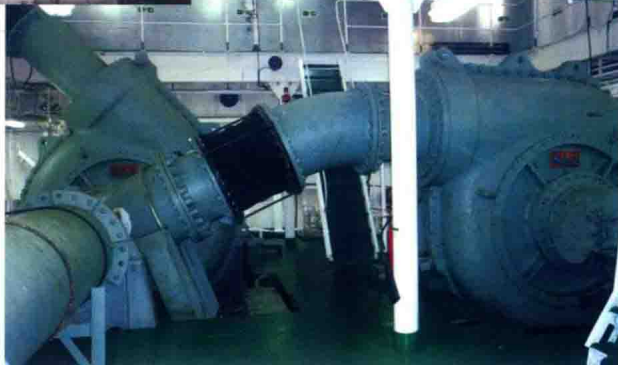
中交天津航道局天极号挖泥船800WN型45度、90度舱内泵
