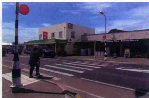
图2 新西兰的斑马线无信号灯控制，只有人行道警示标识
