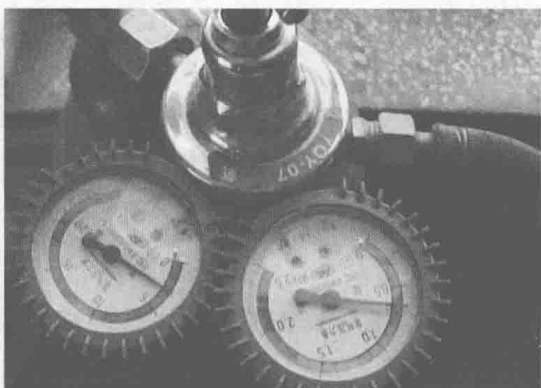
图 1-17 氧气表（左侧是瓶内压力，右侧是经减压表输出的压力）
