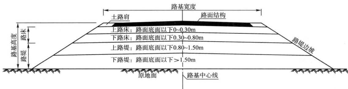
图1-6 路堤各部分结构示意图
