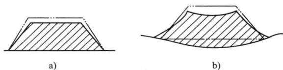
图 1-9 路堤沉陷 a) 堤身沉陷; b) 地基沉陷
