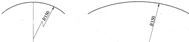
图 1.16 大圆弧半径的标注方法
