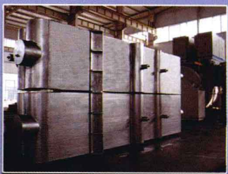
铝制板翅式换热器
