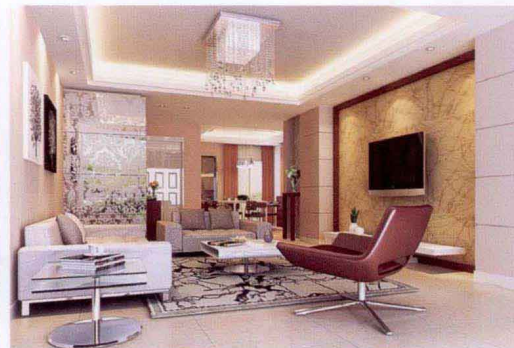
电视墙 [ 墙纸 + 木线条收口 ]
