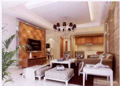
电视墙 [ 布艺软包 + 墙纸 + 不锈钢线条收口 ]
