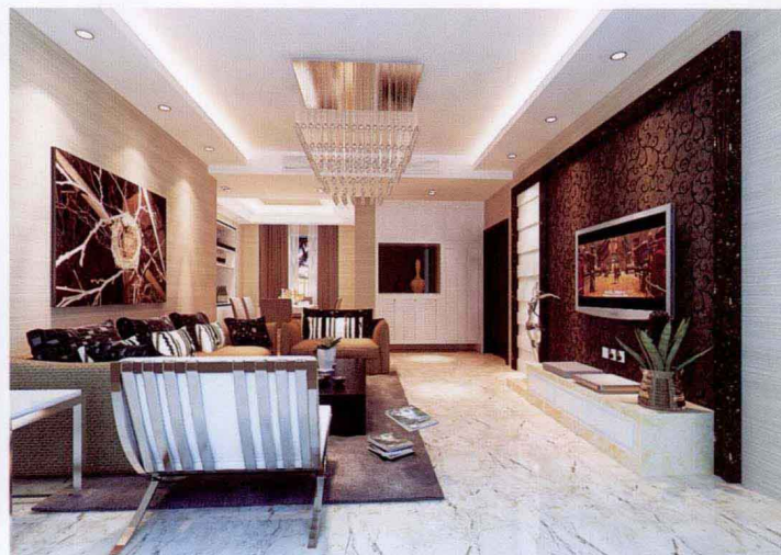
电视墙 [墙纸 + 大理石装饰框] 沙发墙 [木饰面板]
