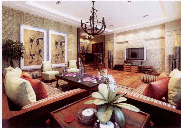
顶面 [ 石膏造型 ] 电视墙 [ 真石漆墙面喷涂 ]
