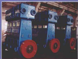
氧、氮压缩机 气量800 ~ 6500m 3 /h
