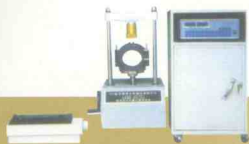
DF-5 型沥青混合料稳定度测定
