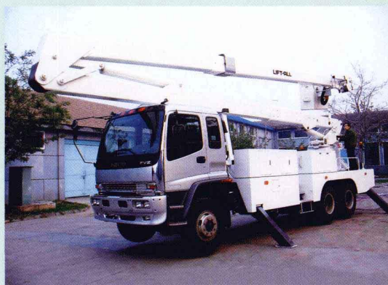
北京三兴汽车厂生产的25米高空作业车
