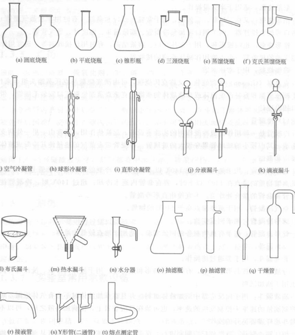
图 1-1 有机化学实验常用普通玻璃仪器
