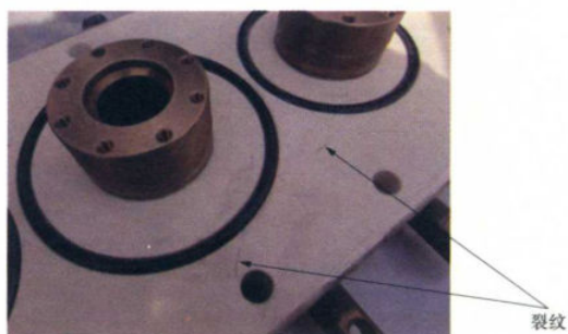
图 1-9 绝缘子 B 相密封线圈处有明显裂纹
