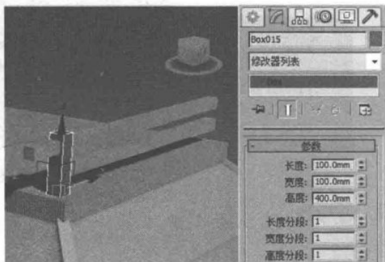
图 1.1.24 制作栏杆立柱
