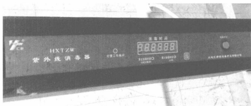
图1-14 水族箱循环水消毒设备（紫外线消毒系统）
