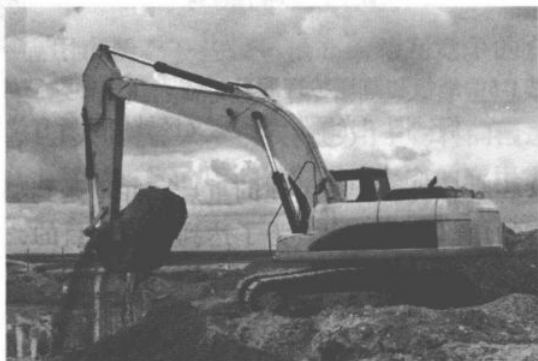
图 1-7 野外机器人。野外机器人必须与它所处的环境密切结合。(左图) 与左图所示的机器类似的半自动伐木归堆机, 被用来收集整理砍伐的树木; (右图) 自动挖掘机的原型机可进行大规模挖掘作业, 以应对那些需要在短时间内装载大量泥土的应用场景
