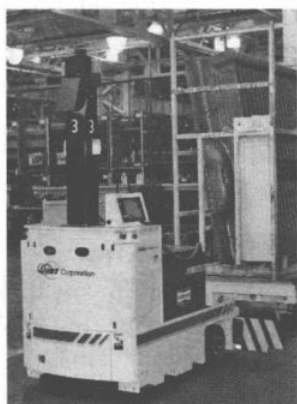
图 1-2 牵引式 AGV (美国费城 JBT 公司)。这些激光导引型自主移动机器人在工厂中用于物料搬运
