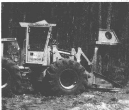
图 1-7 野外机器人。野外机器人必须与它所处的环境密切结合。(左图) 与左图所示的机器类似的半自动伐木归堆机, 被用来收集整理砍伐的树木; (右图) 自动挖掘机的原型机可进行大规模挖掘作业, 以应对那些需要在短时间内装载大量泥土的应用场景
