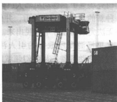
图 1-3 集装箱跨运车。用于轮船上集装箱的装卸，这些自动化的运输车可能是目前已投入使用的最大尺寸的 AGV
