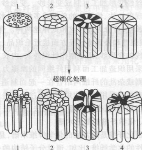
图 0.3 复合裂离法和复合海岛法纺制超细纤维
