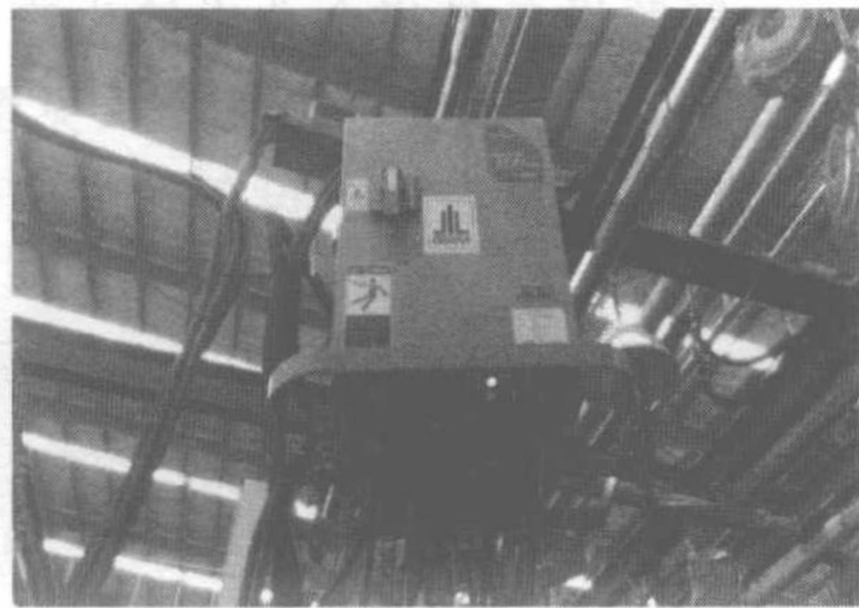
图 1-8 悬挂式点焊机
