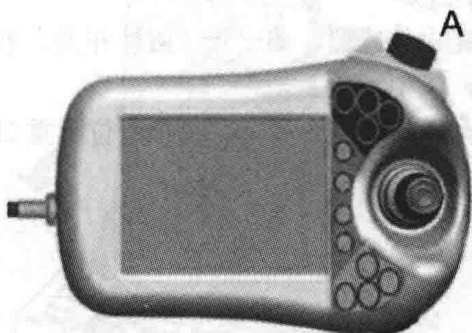
图 1-5 示教器结构图 (A—紧急停止按钮)
