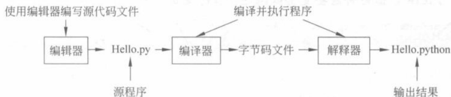
图 1-1-8 编写、编译和执行 Python 程序的流程
