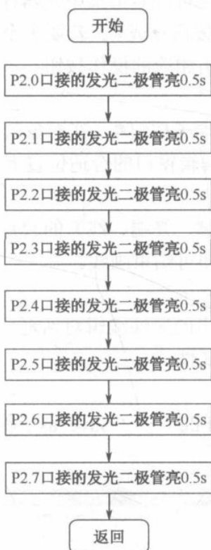
图 1-1-9 8 位流水灯循环点亮程序流程图
