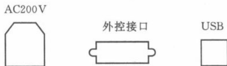
图 1-5 CS 系列工作站后面板电源与微机接口插座
