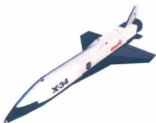
图 1-4 设计飞行速度达 8 倍声速、设计飞行高度达 80 千米的 X-34 试验机(美国)
