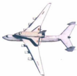
图 1-2 最大起飞重量约 600 吨的安-225运输机(乌克兰)背负着“暴风雪”号航天飞机(俄罗斯)
