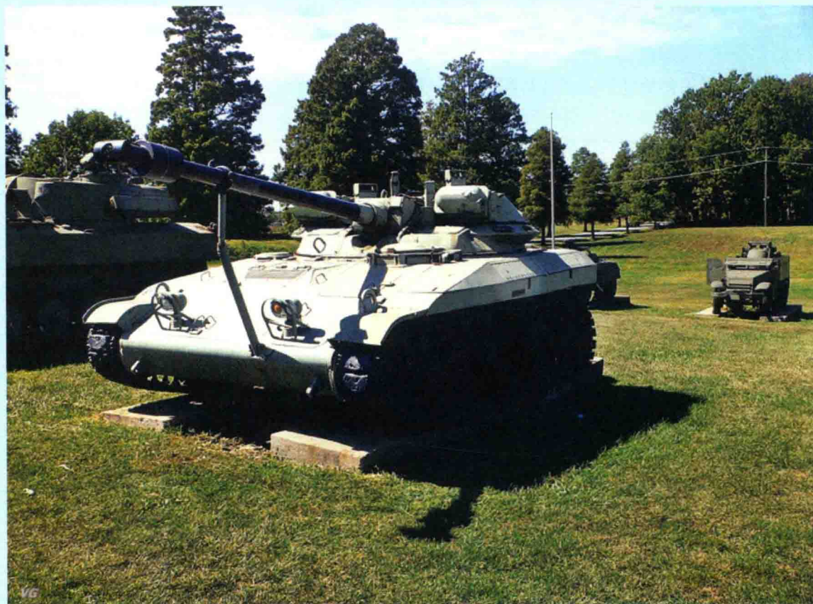
采用开裂式炮塔设计的T-92轻型坦克样车
