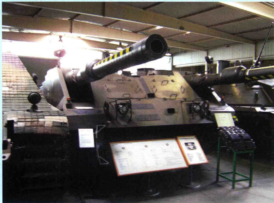
西德 VT1-2 双炮无炮塔式坦克试验车
