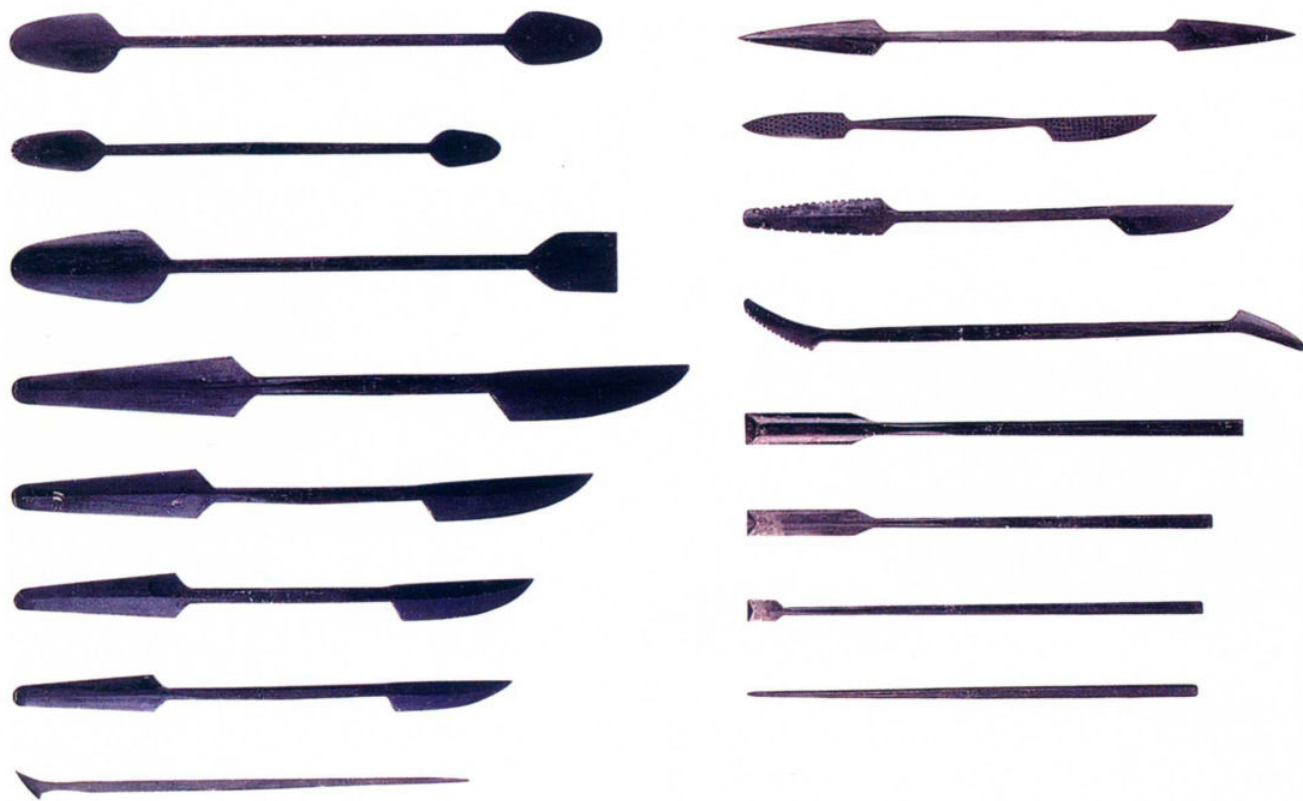
铁制刮刀： 这些铁制刮刀主要用于黏土、油泥、工业设计黏土、石膏等材料制作模型时的堆高、切削和剥离等用途，是十分坚固的刮刀。种类很多，可根据用途进行挑选。
