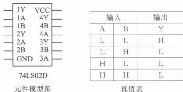
图 1.23 74LS02 模型图及真值表
